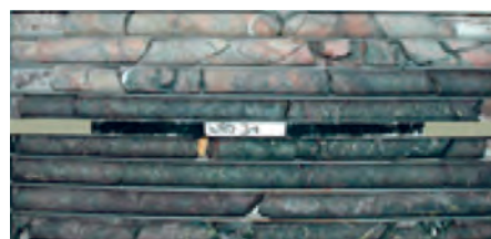
الف) مغزه‌گیری با گمانه‌های اکتشافی
