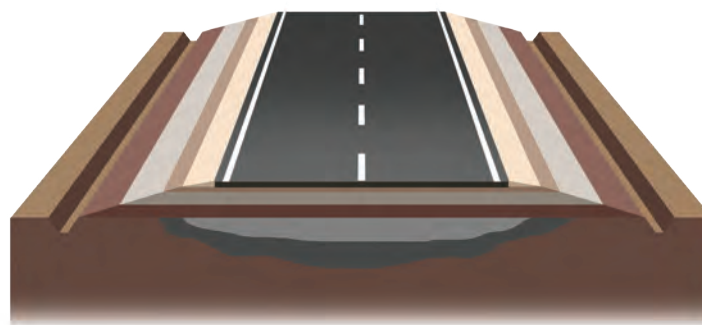
(الف) لایه‌های مختلف راه بر روی بستر طبیعی
