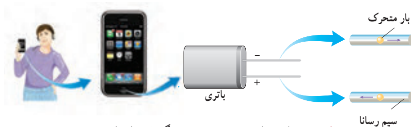
شکل ۲-۱ انرژی از باتری به صفحه نمایشگر تلفن، از طریق سیم‌های رسانایی که در آنها بارهای الکتریکی در جریان‌اند، منتقل می‌شود.
