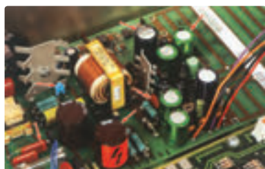
شکل ۱-۳۹ مدار یک تقویت کننده که شامل چند خازن است. برخی از خازن ها با پیکان مشخص شده اند.
