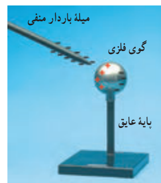
شکل ۳۰- نزدیک کردن میله باردار منفی به گوی فلزی خنثایی که روی پایه عایقی قرار گرفته است، موجب ایجاد بارهای القایی مثبت و منفی در دو طرف گوی فلزی می‌شود.
