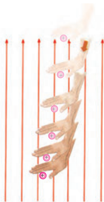
شکل ۲۷-۱ نیروی دست، بار +q را در خلاف جهت میدان الکتریکی جابه‌جا می‌کند.
