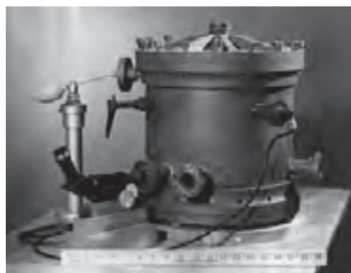
اسباب آزمایش اولیه میلیکان و طرحی از آن
