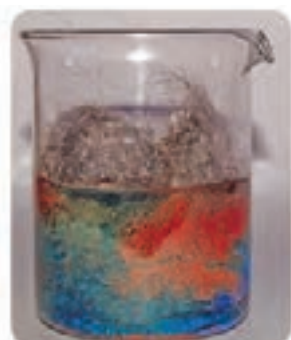
● واکنش الیاف آهن با محلول مس (II) سولفات.
